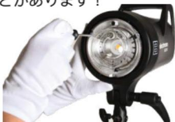
3. ガラスドームを取り外すには、Torx TX10ドライバーが必要です。リフレクターディッシュの内側の金属リングでガラスドームを固定している3本のネジを取り外します。
